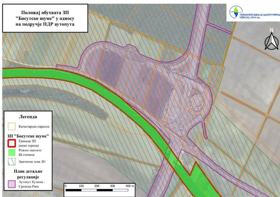
Слика 110: Усаглашавање граница СРП „Босутске шуме“ са изградњом аутопута Кузмин – Сремска Рача, локалитет мост на Босуту. Заштићено подручје пролази испод моста, изузети су конструкција моста и искључење са аутопута.
